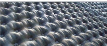
**Incomat® FP (Filterpoint)** – Colchão para controle de erosão com pontos de drenagem, que reduzem as pressões hidrostáticas, para revestimento de margens e leitos sujeitos a erosão.
